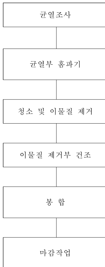
<그림 4.2.14> 교면포장 아스팔트 균열보수
